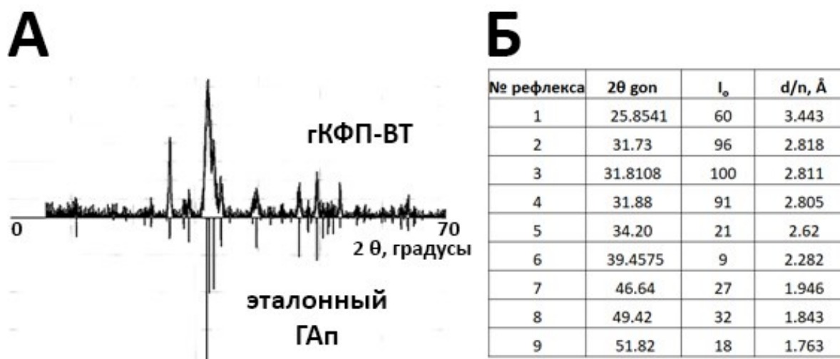
Рисунок 11 – Дифрактограмма подвергнутого температурной обработке гКФП (А) и экспериментальные значения углов ( 2\theta ), относительных интенсивностей ( I_0 ) и межплоскостных расстояний ( d/n ) для дифрактограммы гКФП-ВТ (Б)
